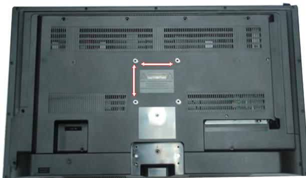
Spécification de montage : **100 mm x 100 mm** en utilisant une vis **M6**. La longueur de la vis ne doit pas dépasser **8mm**. Veuillez noter : La longueur de **8mm** de la vis se réfère à la profondeur de la vis dans les trous de montage. Lorsque vous achetez des vis, vous devez ajouter les 8mm initiaux à l'épaisseur de votre plaque de montage afin d'obtenir la longueur totale de la vis.
